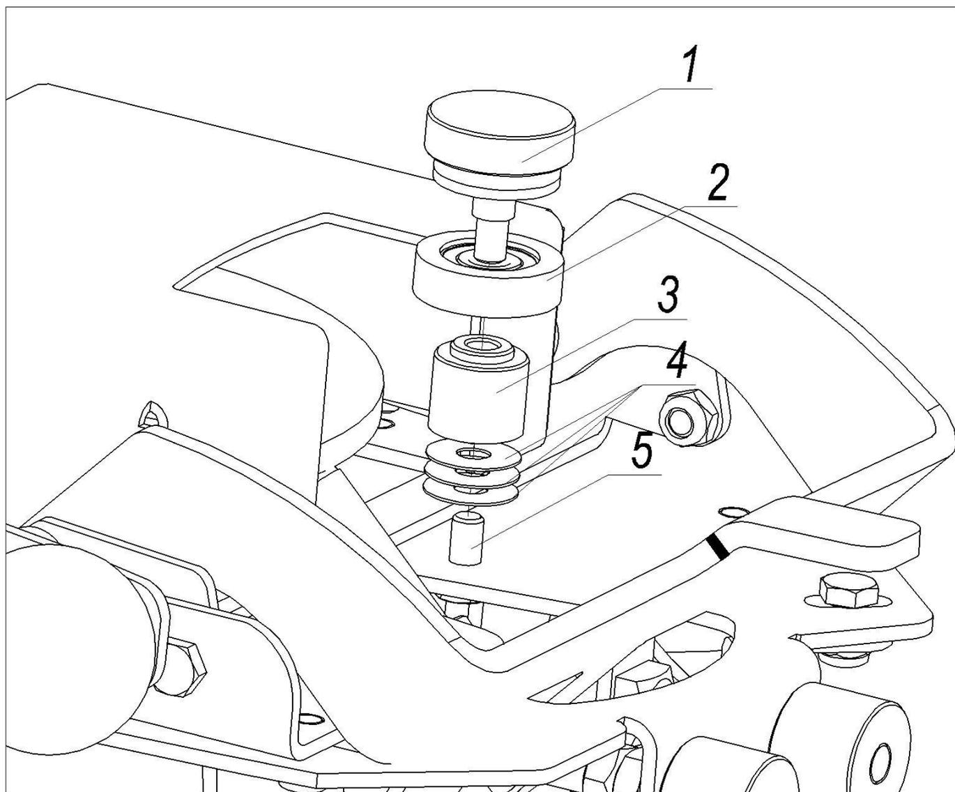
Регулировка оснастки производится один раз путем подкладывания под втулку оснастки регулировочных шайб, при этом производится измерение расстояния между верхней кромкой диска и верхней частью втулки. Расстояние должно равняться 7мм.
